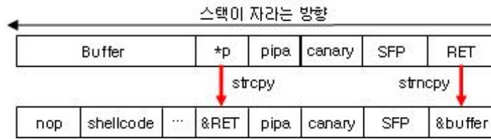
그림 14. Bypass Stack Guard and Stack Shield with pointer
